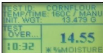
La pantalla muestra el % de humedad, % sólidos, peso, tiempo, temperatura, curva de secado y más.
