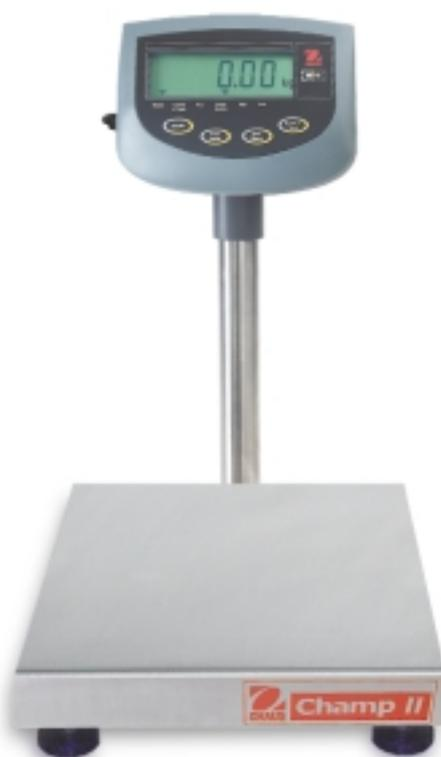
Suministradas en condiciones «plug & play», las básculas Champ II son fáciles de instalar y de manejo simple. La estructura de su robusta base (marco de acero al carbono), su célula de carga IP67 y su plato de carga de acero inoxidable ASI 304 garantizan resultados estables y larga durabilidad para pesadas básicas ó de tipo Aprobado CE.
