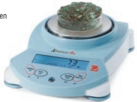
**Pesada en Porcentajes** – Esta aplicación se usa para comparar muestras para dosificación, formulación, ó comprobación de peso rápida. Ponga su peso de referencia en el plato, pulse una tecla, y el display le mostrará en porcentaje la diferencia entre el peso de referencia en memoria y el de la muestra a comprobar.
